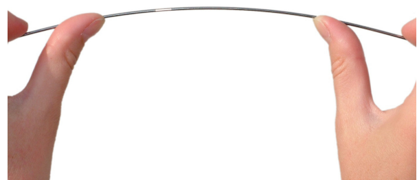
MICRO 100® ist ein spezielles Feinstkorn-Hartmetall mit extremer Biege- und Bruchfestigkeit, wie der Praxistest beweist: Der Stab biegt sich deutlich, doch er bricht nicht.
